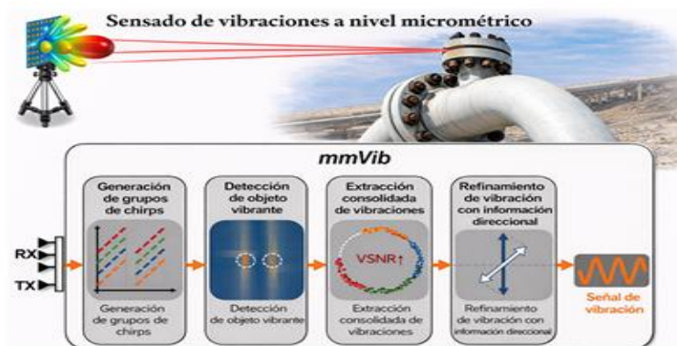
Figura 1: Descripción de la tecnología de medición de vibraciones por radar milimétrico
