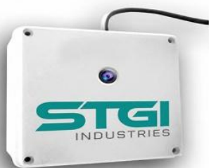
Figura 1: Detector de forma de chorro y ángulo
